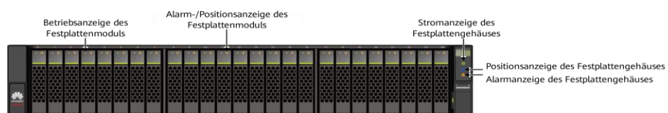
Abbildung 3-100 Anzeigen am Frontpanel eines Festplattengehäuses
